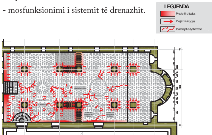
Fig. 83 Plani i deformimeve dhe shtypjes së sipërfaqes së dyshemesë (prezantimi i Grupit 3)
