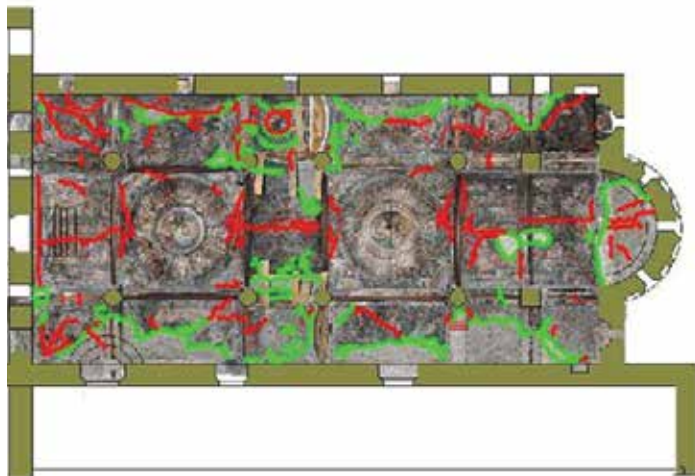
Fig. 81 Prezantimi i çarjeve: me të kuqe çarje aktuale, me të gjelbër çarje të mbyllura gjatë restaurimit të fundit (prezantimi i Grupit 4)
